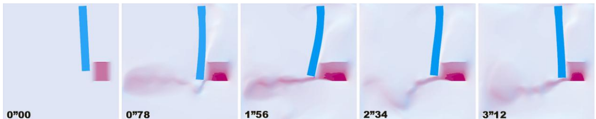
図 1 上端固定条件での弾性体と噴出流体の連成シミュレーション[速度場による可視化, 左下は実時間]
